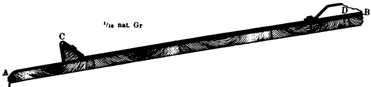
Papprinne auf dem Dache liegend. Durchschnitt.
