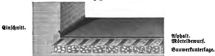
Muster einer mit Asphalt bedeckten Terrasse.
