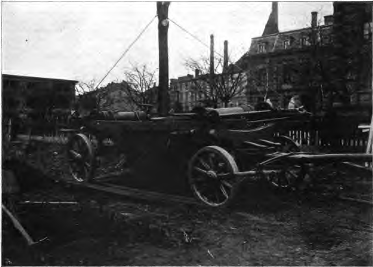
Verpflanzwagen, nach den Angaben des Herrn Stadt-Garteninspektors Ries, Karlsruhe, in der Wagenfabrik von G. Blankelmann, Dortmund, angefertigt. Originalaufnahme für „Die Gartenkunst“.
