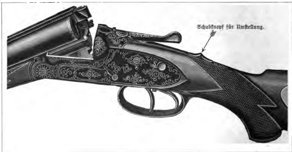
Abb. 49. Selbstspanner-Dreilauf-Gewehr, Modell 1901, hahnlos.
