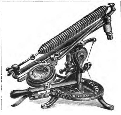
Abb. 58. Amerikanische Original-Würgmaschine zu den „Blue Rod“-Tauben oder „Fley Target“.
