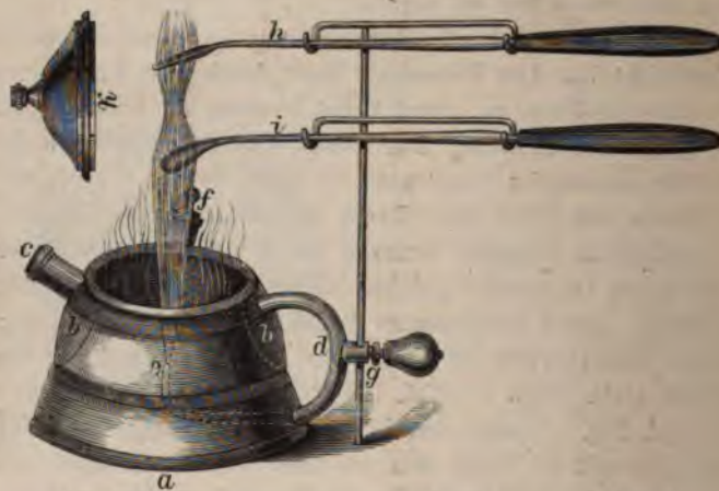
Fig. 147. Lampe zum Erhitzen der Glüheisen. (Fürst.)
