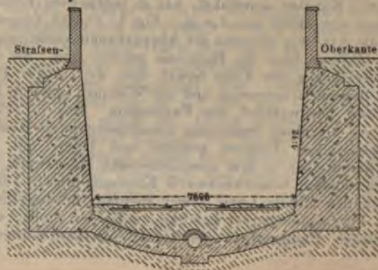
Fig. 16. Futtermauer aus Beton (1884).
