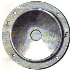
Fig. 337. Telephon-Mundstück. E Spirale. Mitte: eiserne Membran
