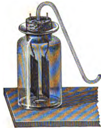
Fig. 225. Voltmeter (Apparat zur Entwicklung von Knallgas).
