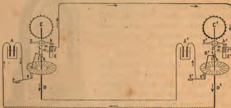
Fig. 36. Hughes' Typendrucktelegraph, Stromlauf.
