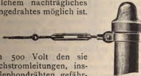
Fig. 34. Spannschloß am Mast.
