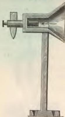
Oeffnung einen verticalen Bolzen aus Kupfer trägt. Dieser kupferne Bolzen wird dadurch auf die zum Schmelzen des Zinns erforderliche Temperatur gebracht, dass von hinten eine Gasflamme in das Gehäuse hineinragt. Die Temperatur sollte nie höher gehalten werden, als eben zur Arbeit nöthig ist, damit das Springen der Ballons durchaus vermieden wird. Die Löthstelle darf nur einen kurzen Augenblick mit dem Bolzen in Berührung gebracht werden. Zu allen Gypse-
