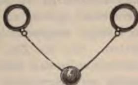
ist die Verwendung des Bleistreifens in der Bleischaltung dargestellt. Damit die Streifen auch bei grösseren Stromstärken sicher wirken, wendet man nicht nur einen Draht von entsprechendem Querschnitt an, sondern es werden deren mehrere nebeneinander geschaltet. \*)
