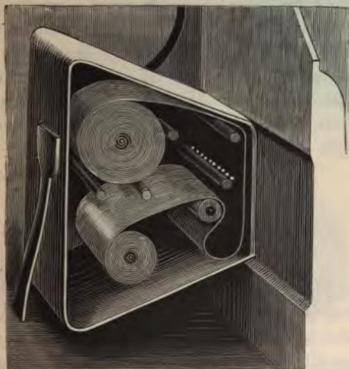
dem Spalt sich abrollende Band und zeichnet auf das Band eine dunkle Linie ein, welche eine Stunde bedeutet. Jede Stunde wiederholt sich dieser Vorgang und die Breite des Bandes bedeckt sich mit gleichmässig entfernten parallelen Linien, deren Zwischenraum einer Stunde Arbeit des Uhrwerkes gleichkommt.
