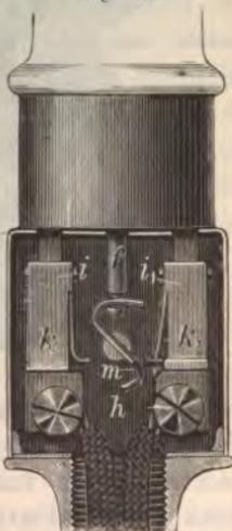
zweifachen Umschalter bethätigt. Fig. 49 zeigt die Einrichtung in perspectivischer Ansicht. In dem Gehäuse *G* befindet sich ein Elektromagnet von hohem Widerstand, dessen Windungen im Nebenschluss zur Lampe liegen. Der bewegliche Deckel *A* bildet den Anker des Magneten. An den Klemmen *x* und *y* sind sowohl die Leitungen,
