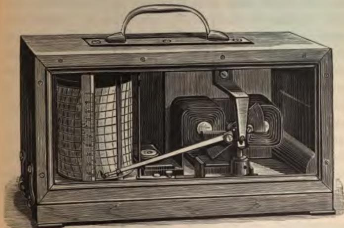
**Irish** combinirt einen Verbrauchsmesser mit einem Regulator. Derselbe besteht aus einem Solenoid, welches von dem zu messenden Strome durchflossen wird. Der Eisenkern des Solenoids, welcher je nach der Intensität eingesaugt oder ausgestossen wird, trägt seine Variationen mittelst eines Schreibstiftes auf eine Rolle endlosen Papiers ein. Das andere Ende des Kernes, zu einem Kolben ausgebildet, regelt durch Verdrängung von Quecksilber den Widerstand im Hauptstromkreise und
