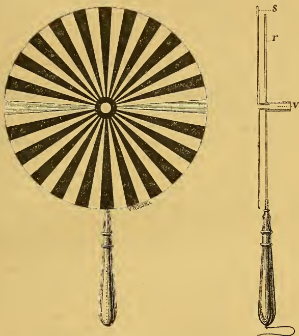
Fig. 43. — Astigmomètre de E. Berger. s , disque à rayons; r , disque à cercles concentriques; v , visoir.
