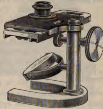
FIG. 95.—FLEISCHL'S HEMOMETER. (Da Costa.)
