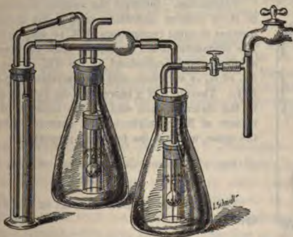
FIG. 174.—FOLIN AMMONIA APPARATUS.
