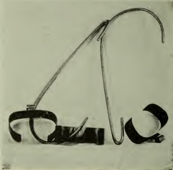
82. Spangen und Haken für die Befestigung des Sprengstoffes.
